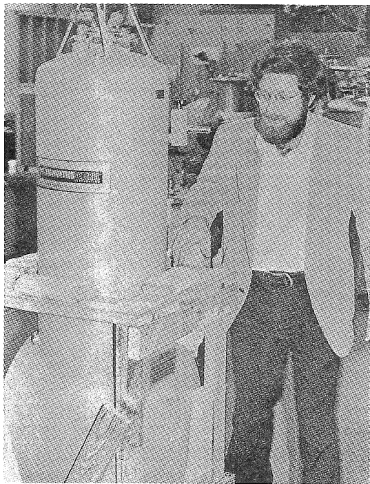
図 4 in-vivo NMR 分光用超電導マグネット
