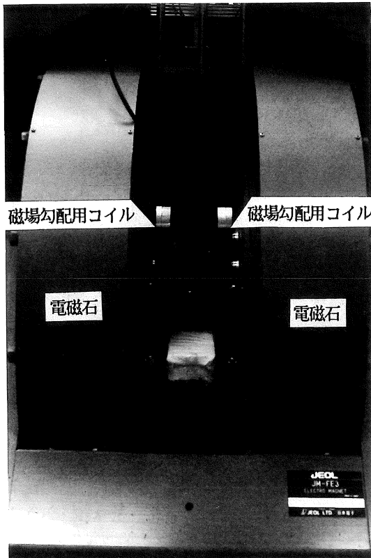
図 1-A. ESR 用電磁石に磁場勾配用コイルを装着した概観。
